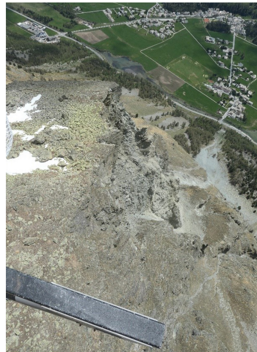
Immagine 3: Vista dall'elicottero: in primo piano la zona di distacco, sotto la falda detritica dove rimane quasi tutto il materiale franato.
