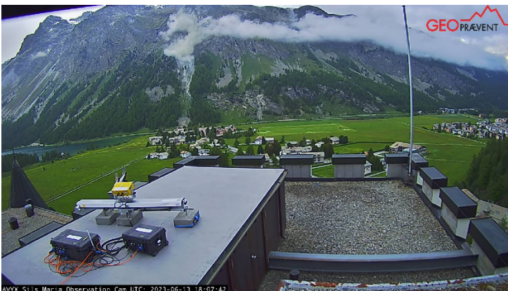
Immagine 4: Fotografia della caduta di massi del 13 giugno 2023, ore 20:07. Il radar per rilevare eventuali cadute di sassi si trova sul tetto dell'hotel Waldhaus a Sils Maria (dispositivo giallo in primo piano).
