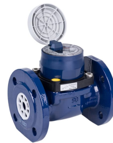
Figura 4-4: Misuratore del deflusso della Vasca raccolta Bürdagh – Meistream mit GWFcoder® DN80, Q3 120, PN 16, L=225 mm
